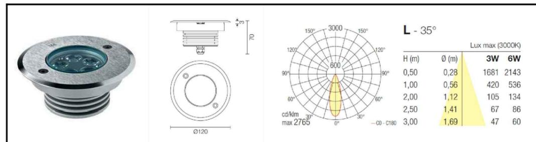
corpo illuminante da incasso a led tipo Luce&Light mod. Bright 3.2 (disegno tecnico e curva fotometrica)
