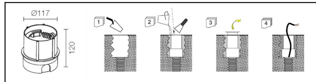
cassaforma per incasso tipo Luce&Light mod. WC0104 (disegno tecnico e istruzioni di montaggio)
